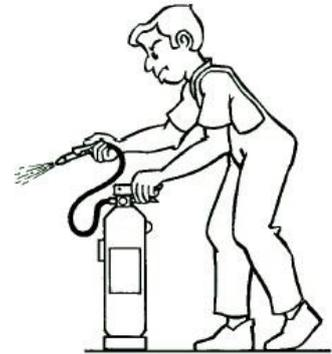
1. Descolgar el extintor asiéndolo por la maneta o asa fija y dejarlo sobre el suelo en posición vertical.
